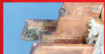
Spuren von Spannungsüberschlägen
